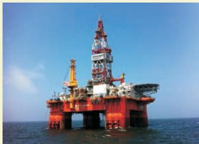
“海洋石油981”在六方面创下世界第一：首次采用200年一遇的台风参数和南海内波作为设计条件，大大提高平台抵御灾害的能力；首次采用3000米水深范围DPS3动力定位、1500米水深范围锚泊定位的组合定位系统，优化节能；首次突破半潜式平台可变载荷9000吨，提高远海作业能力；首次成功研发世界顶级超高强度R5级锚链，引领国际规范的制定；首次在船体关键部位系统安装传感器监测系统，为研究半潜式平台的运动性能、关键结构应力分布、锚泊张力范围等建立系统海上科研平台，为中国半潜式平台应用于深海的开发提供了科学而宝贵的设计依据；首次采用最先进的本质安全型水下防喷器系统，在紧急情况下可自动关闭井口，能有效防止漏油事故发生。
