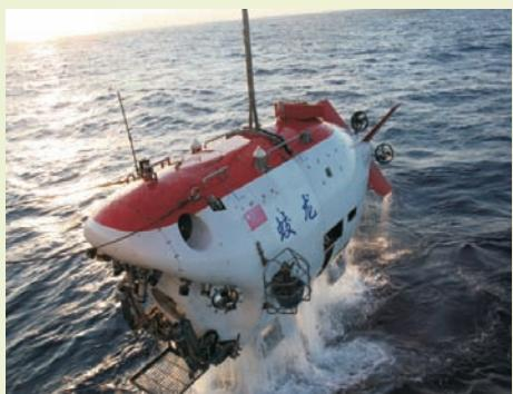
中国船舶重工集团公司第七〇二研究所技术抓总的“蛟龙”号载人潜水器在东太平洋中国大洋协会多金属结核勘探合同区（简称CC区）成功完成了5000米级海上试验，最大下潜深度达到5188米。5000米级海试使“蛟龙”号极端深海环境作业能力得到初步验证，多次辗转不同试验海区也增强了对CC区资源与环境的认识，使得我国成为继美国、日本、俄罗斯和法国之后第5个具备5000米级载人深潜能力的国家。5000米级海试是中国载人深潜首次真正意义上挑战深海极端环境，是继2010年3000米级海试成功后我国深海技术领域的又一个里程碑，标志着我国深海载人技术已跨入国际第一梯队，具备了远征大洋、应对复杂海洋环境的能力。
