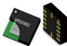
7月，矽睿科技成功推出国内首款单芯片三轴MEMS陀螺仪QMG6982，该产品首次将MEMS陀螺仪器件和专用集成电路（ASIC）器件集成在单一硅片上，简化了内部连线，减少了内部封装的绑定金线，提升了封装可靠性。
