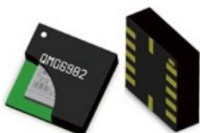
7月，矽睿科技成功推出国内首款单芯片三轴MEMS陀螺仪QMG6982，该产品首次将MEMS陀螺仪器件和专用集成电路（ASIC）器件集成在单一硅片上，简化了内部连线，减少了内部封装的绑定金线，提升了封装可靠性。
