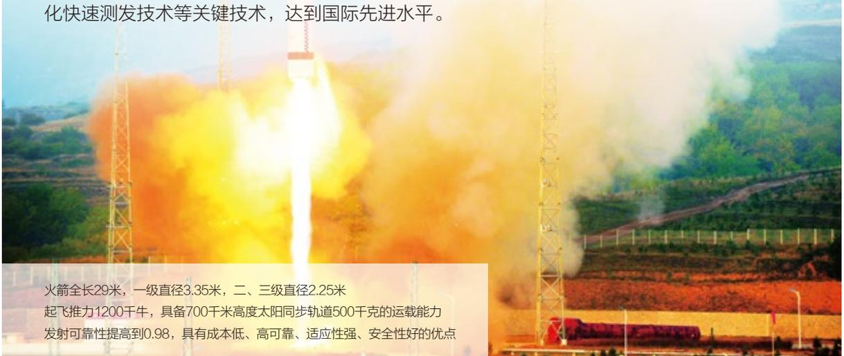
火箭全长29米，一级直径3.35米，二、三级直径2.25米
